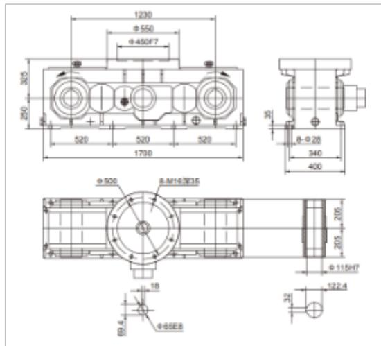
减速机采用油池飞溅润滑，在运行前用户需将通气孔的螺塞取下，换上通气塞。按不同的安装位置，并打开油位塞螺钉检查油位线的高度，从油位塞处加油至润滑油从油位塞螺孔溢出为止，拧上油位塞确定无误后，方可进行空载试运转，时间不得少于2小时。运转应平稳，无冲击、振动、杂音及渗漏油现象，发现异常应及时排除。经过一定时期应再检查油位，以防止机壳可能造成的泄漏，如环境温度过高或过低时，可改变润滑油的牌号。上海鲲翱机电欢迎您的咨询！安徽螺旋伞减速机生产厂商关于减速机的类别有哪些？
